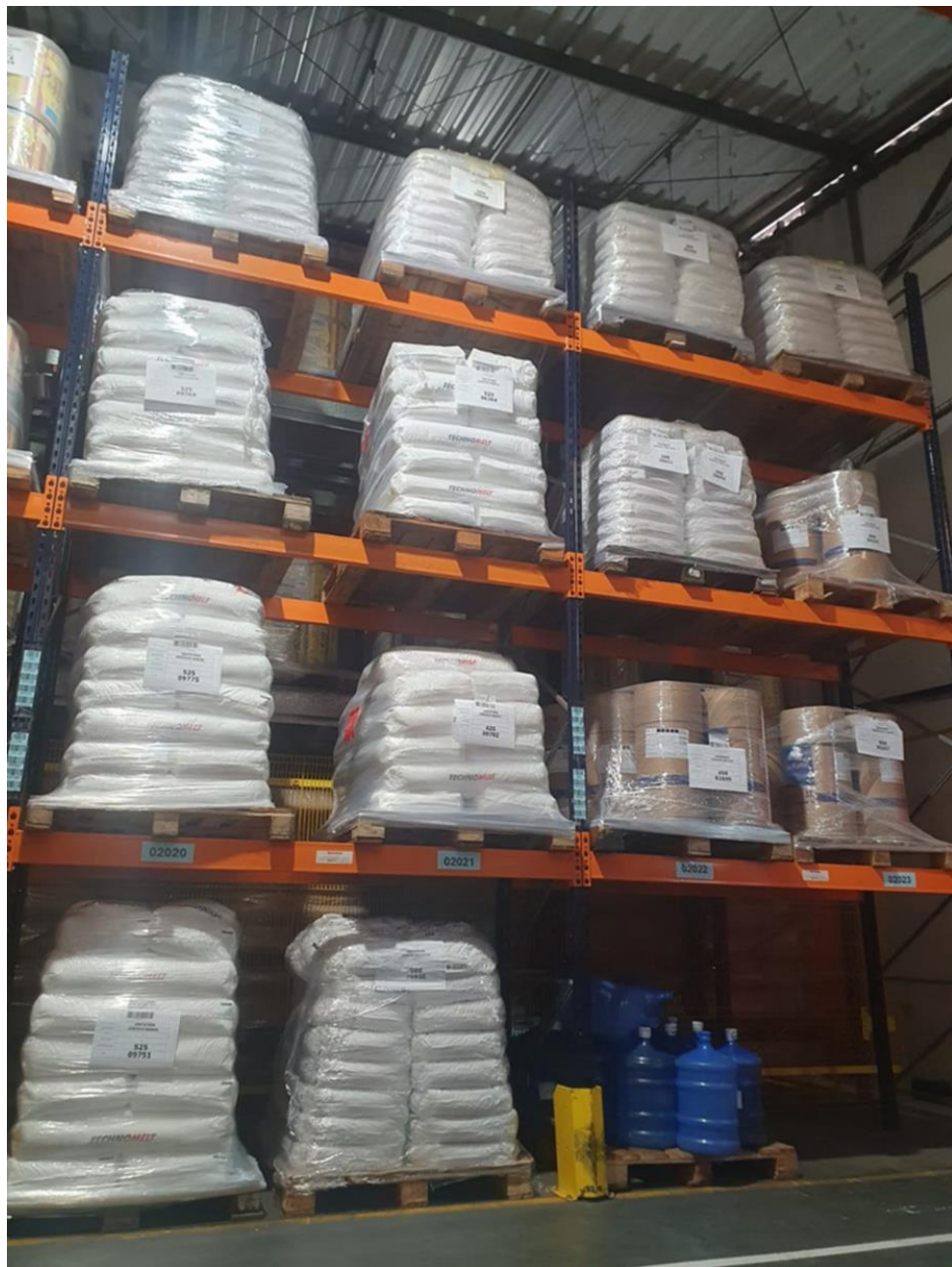
Figura 3 – Estrutura de armazenagem após a otimização (quatro níveis).
