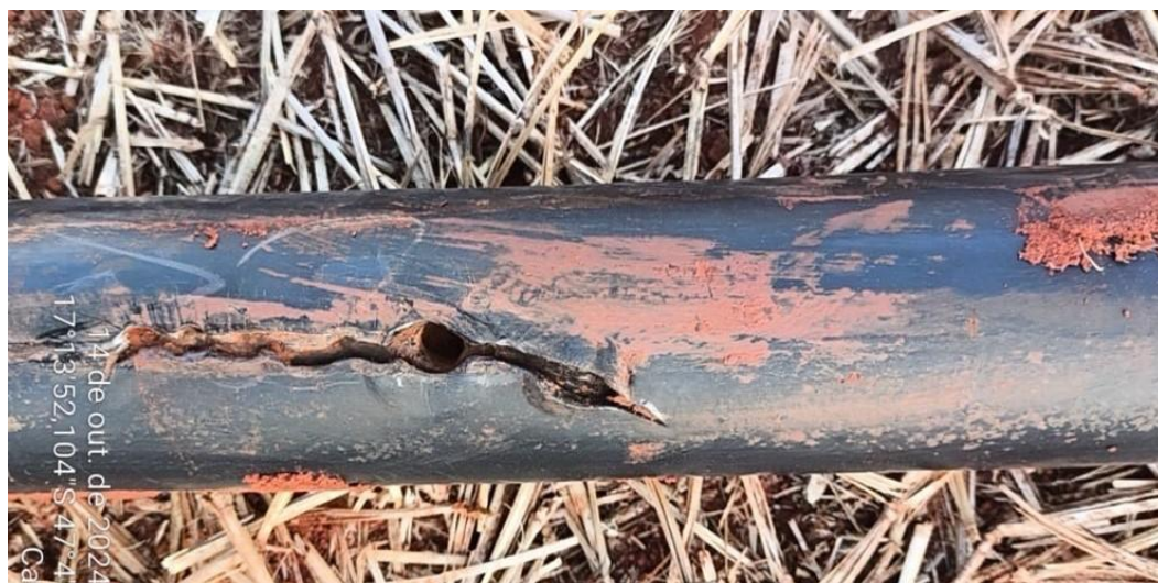
Figura 1: Cabo da Fase A da LT com falta de isolamento devido à alta umidade do local ocorrendo o curto-circuito monofásico-terra.
