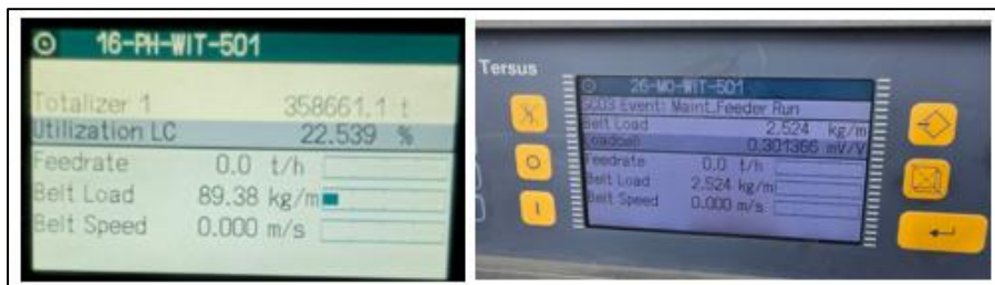
Figura 28 - Parâmetros (UTILIZATION LC (%) e LOADCELL(mV/V)).
