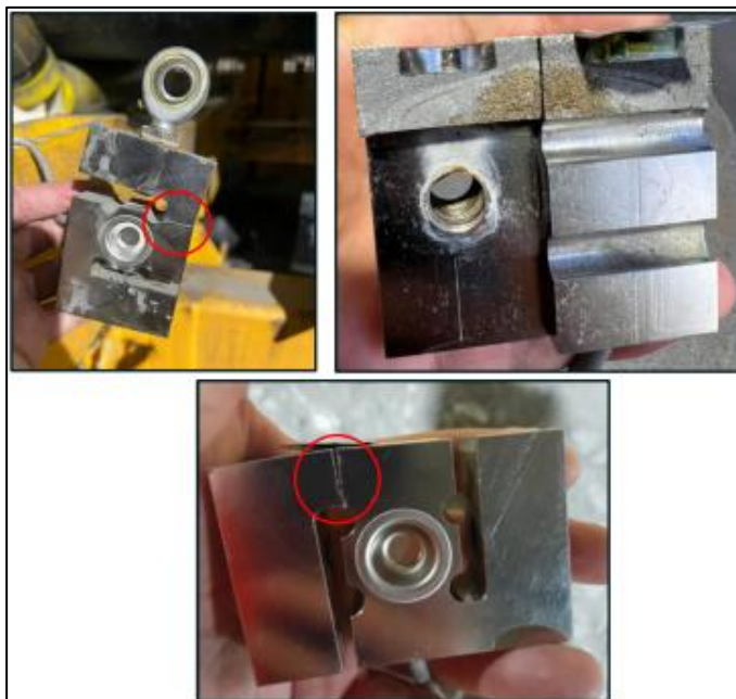
Figura 20 - Célula de carga danificada.
