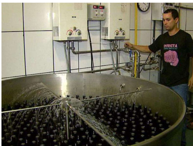
Figura 5 - Processo de pasteurização da cerveja
