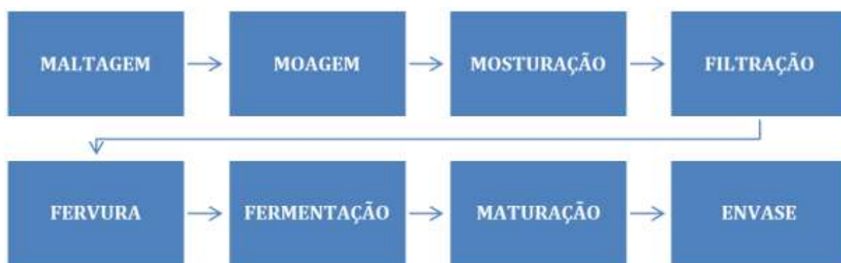
Figura 1 - Esquema do processo de fabricação da cerveja.
