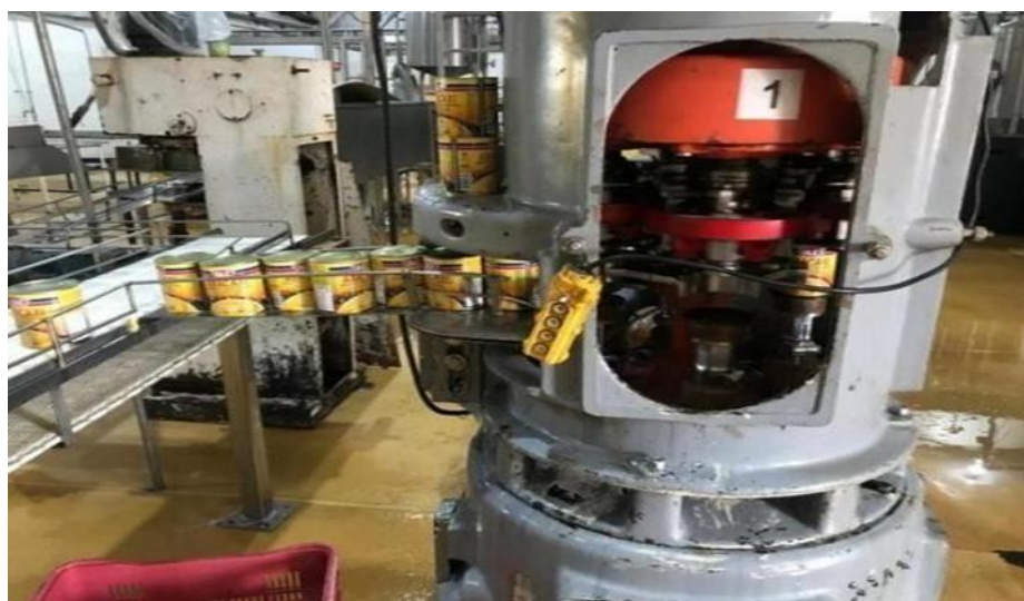
Figura 8 - Recravadeira, máquina que faz o fechamento e vedação das latas
