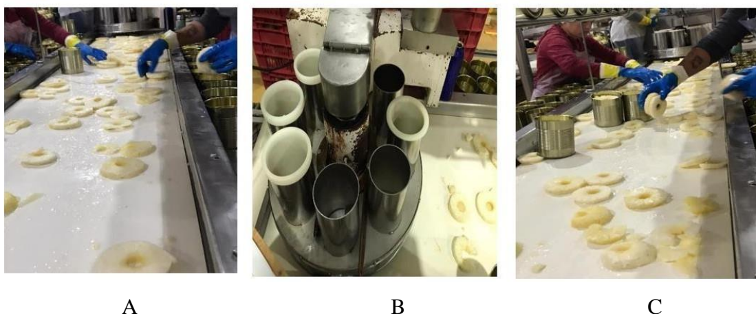
Figura 6 - Fatiadeira que corta os frutos em rodelas e esteira de seleção das rodelas
