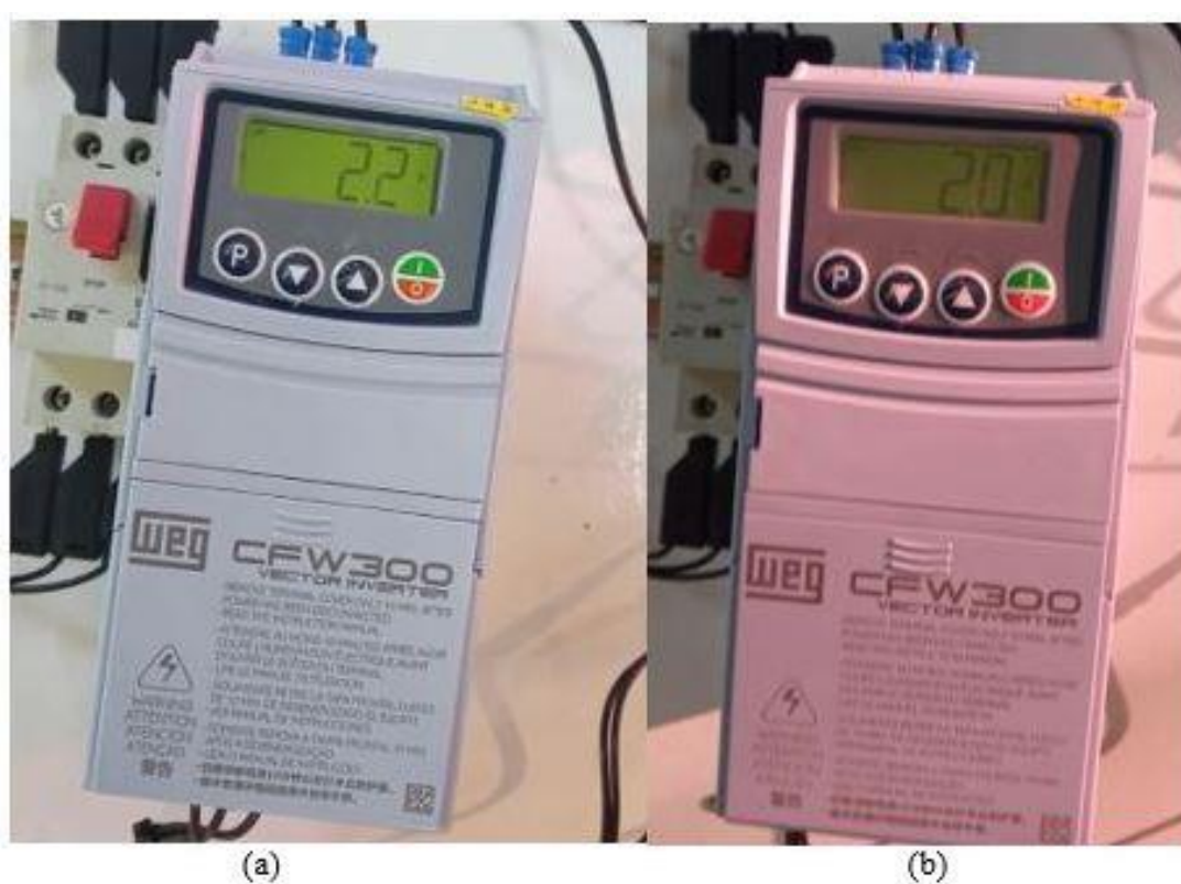
Figura 22 - Comparação da medição de corrente no inversor de frequência em 60Hz.
