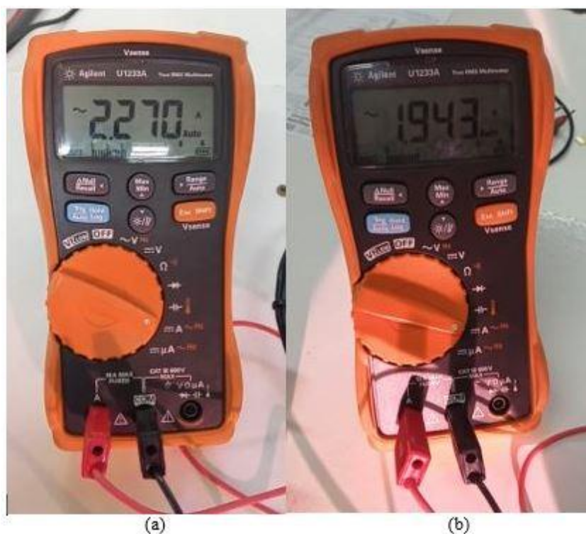
Figura 23 - Comparação da medição de corrente no multímetro em 60Hz.
