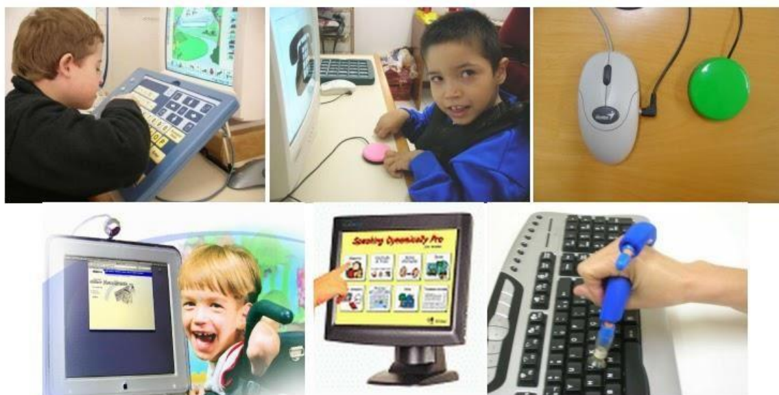
Imagem 5: Teclado Intellikeys, acionadores com mouse adaptado, mouse por movimento da cabeça, monitor com tela de toque e órtese para digitação.
