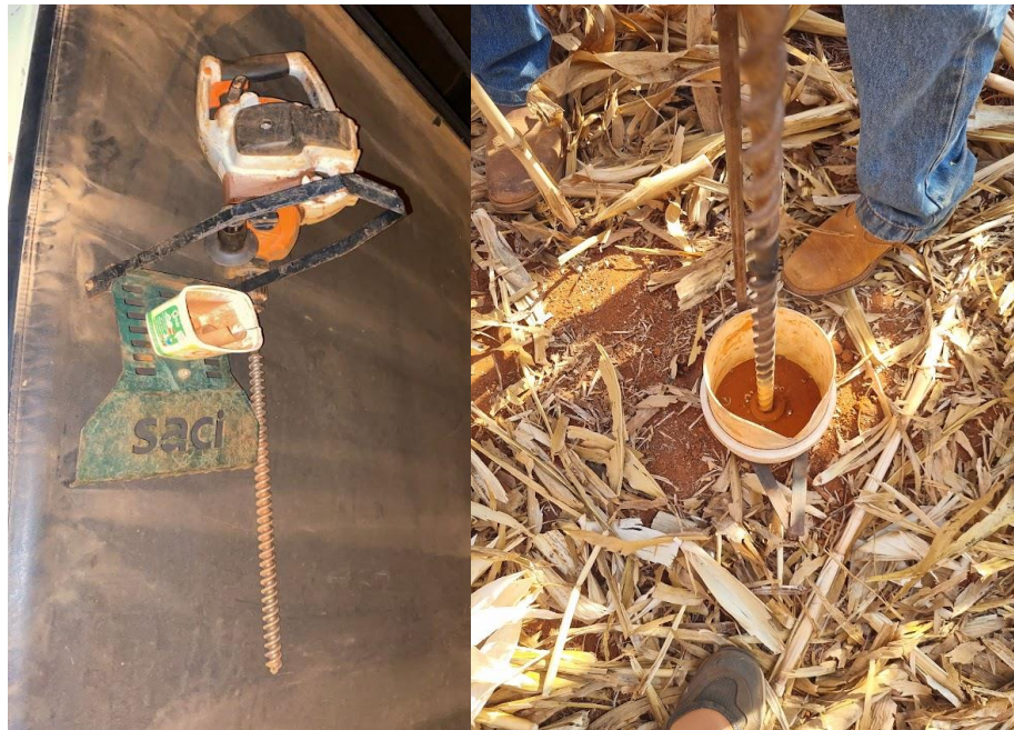
Figura 5. Coleta de amostras de solo utilizando a furadeira STIHL tipo “Saci” nas profundidades de 0 a 0,30 m, para análise química de macronutrientes.
