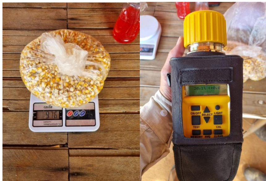
Figura 6. Quantificação da produção nas linhas centrais de cada parcela experimental e determinação da umidade, para corrigir valores para 13% de umidade.
