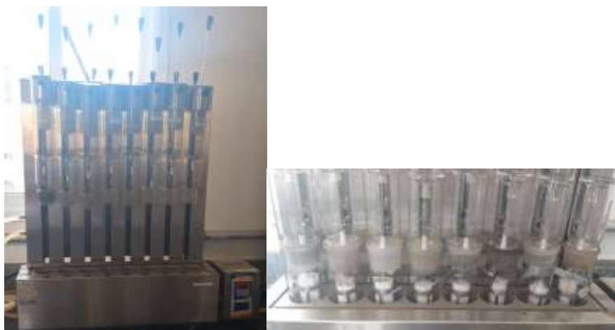
Figura 10 - Extrator de Soxhlet. Tecnal TE -044, nas dependências do IFTM Campus de Uberlândia
