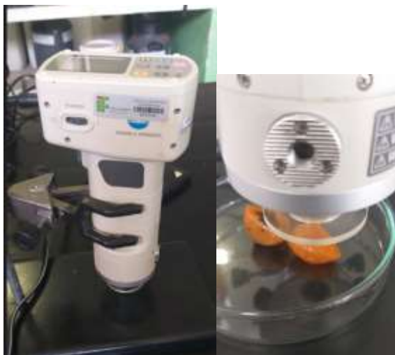
Figura 9 - Aparelho de medição para índice de cor, Konica Minolta CR 400, nas dependências do IFTM Campus de Uberlândia
