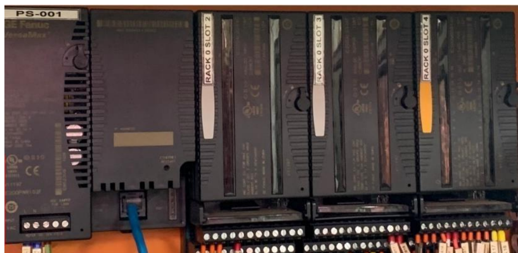
Figura 2 - Foto do CLP GE Fanuc modelo VersaMax IC200CPUE05 existente no painel da planta didática do Laboratório do IFTM campus Paracatu.
