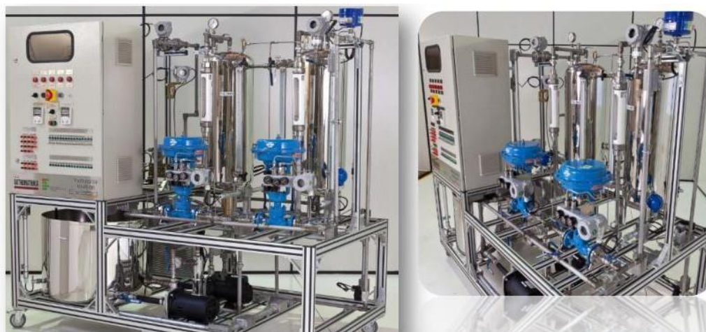
Figura 1 - Planta de ensaios de malhas de controle PDH-ATK 1001 com comunicação HART e sensores SMAR, projetada pelo grupo AUTHOMATHIKA.
