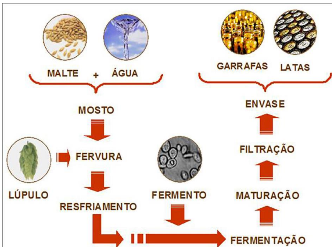
Figura 1- - Processo esquemático de fabricação da cerveja
